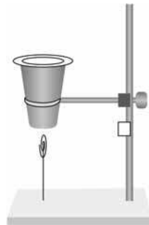
चित्र 13.5 चुंबक का प्रभाव – हवा में लटका पेपर क्लिप
