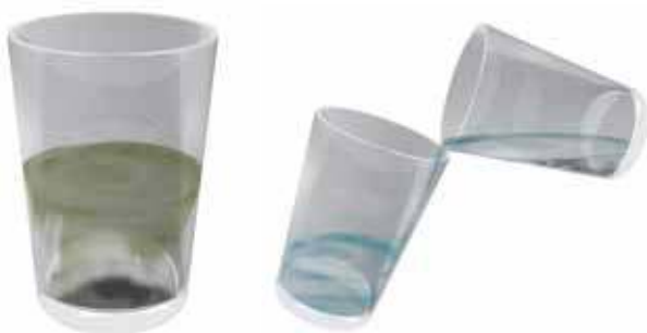
चित्र 5.8 किसी मिश्रण के दो अवयवों को अवसादन तथा निस्तारण द्वारा पृथक करना
